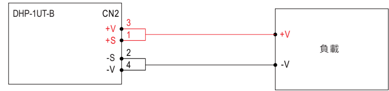
圖5-9 Local Sense配線示意圖
