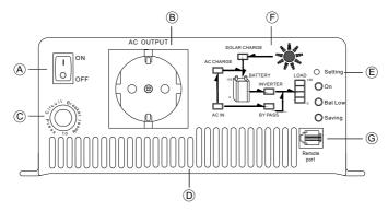
圖3.1 前面板示意圖(TN-1500)
